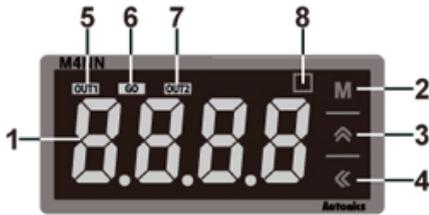
1. Дисплей, отображающий измеренные значения
